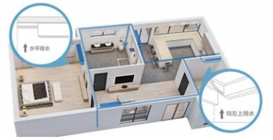
面对多户型住宅，MDV8挂壁机可水平、向上、向下等任意方向排水，汇集至一处集中排水
